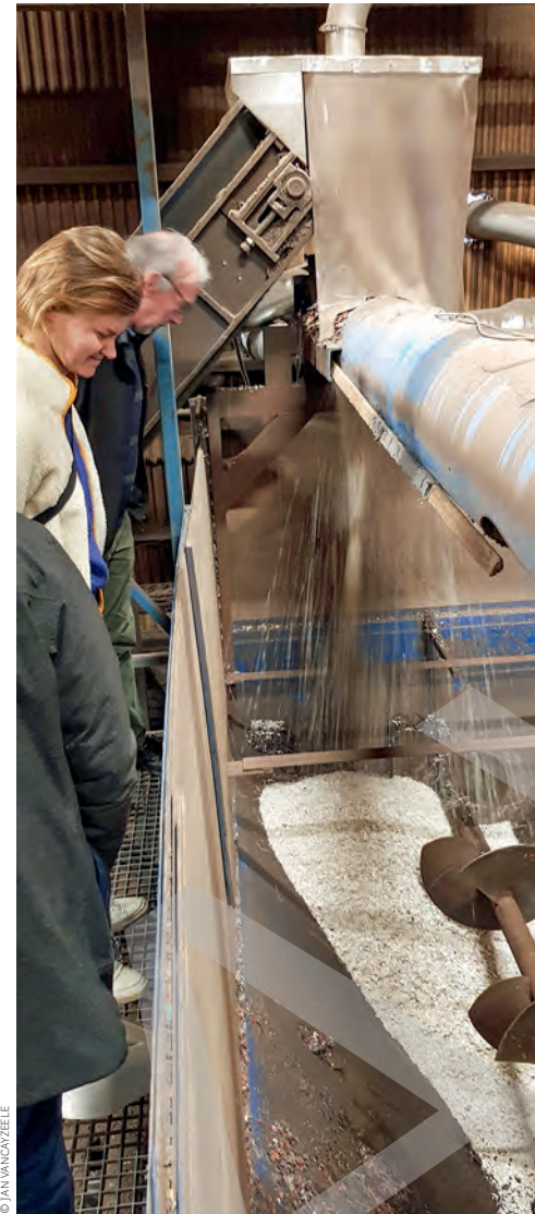
De snippers worden droog gewassen, waardoor de bouw van een afvalwaterreiniging kon worden vermeden.
